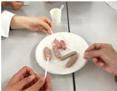
亜硝酸ナトリウムに反応する検査キットを使った実験。ウインナーの断面に試験紙を触れると変色する
